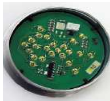
Anzeige Einheit TTD-03.2.016.00 (Ansicht von unten)
