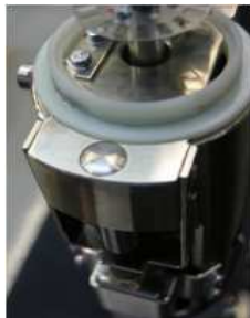
Oberer Pfostenteil: Stoppereinheit, Drehgeberscheibe, Buchse RTD-03.150.20 geöffnet (Seitenansicht)
