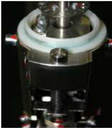
Oberer Pfostenteil: Stoppereinheit, Drehgeberscheibe, Buchse RTD-03.150.20 geschlossen
