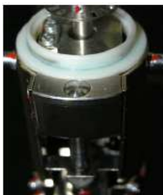
Oberer Pfostenteil: Stoppereinheit, Drehgeberscheibe, Buchse RTD-03.150.20 geöffnet
