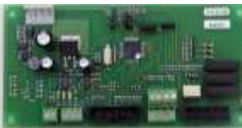
Steuerplatine RTD-03.770.00 (für WMD-04)
