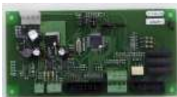
Steuerplatine RTD-03.770.00-02 (für WMD-04)
