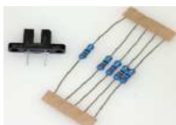
Lichtschranke Microchip TCST-2103 (microchip CNY-37, TCST-2000) / Widerstand MR - 0,5 W - 330 Ohm \pm 5\%
