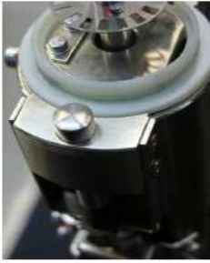
Oberer Pfostenteil: Stoppereinheit, Drehgeberscheibe, Buchse RTD-03.150.20 geschlossen (Seitenansicht)
